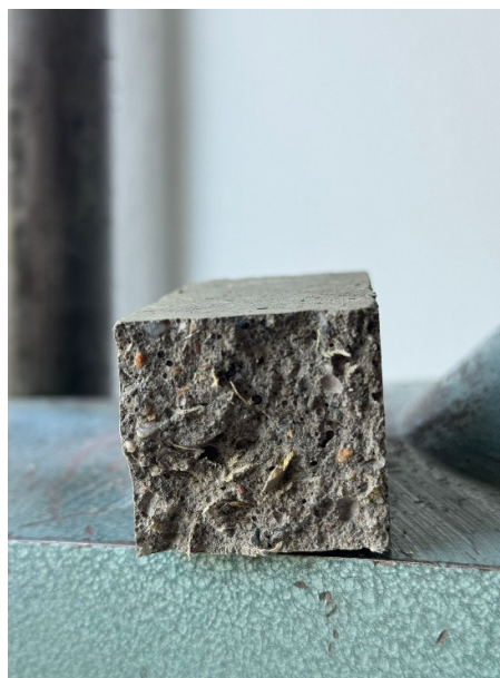
Figura 2. Beton cu rumeguș în compoziție [2]
