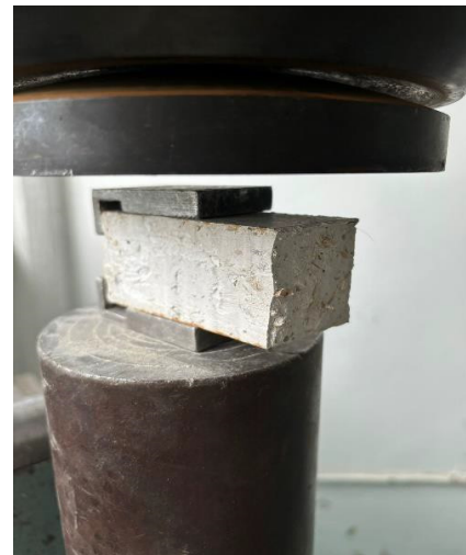
Figura 7. Determinarea rezistenței la compresiune
