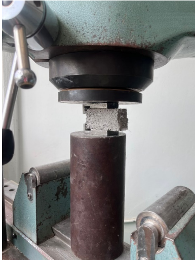
Figura 10. Testarea la compresiune
