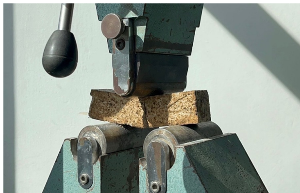
Figura 3. Determinarea rezistenței la întindere prin încovoiere [3]
