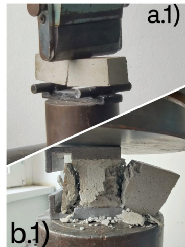
Figura 8. Efectele în urma testelor de rezistență la 2 zile , la întindere prin încovoiere(a) și compresiune(b)
