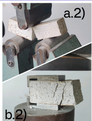
Figura 9. Efectele în urma testelor de rezistență la 7 zile , la întindere prin încovoiere(a) și compresiune(b)
