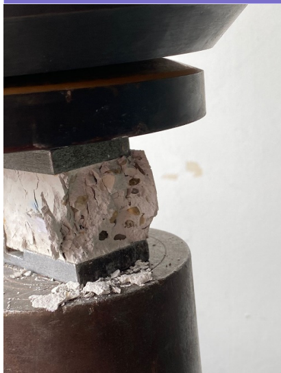
Figura 13. Rezistența la compresiune la 12 zile
