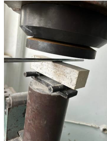
Figura 6. Determinarea rezistenței la întindere
