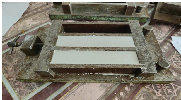
Figura 6. Probele de ipsos cu apă minerală
