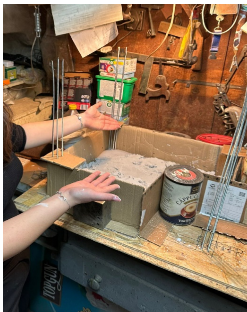
Figura 3. Fundația după turnare în cofrag
