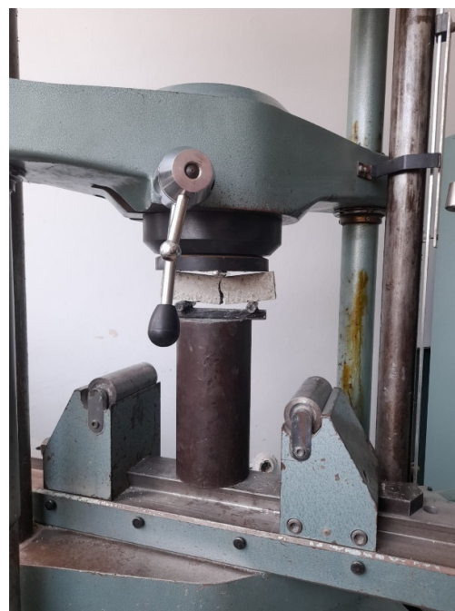
Figura 7. Testare la întindere prin încovoiere
