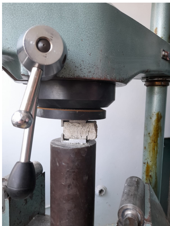
Figura 9. Testare la compresiune
